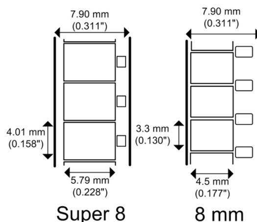
Le **Fuji Single 8** a la même largeur et les mêmes dimensions de pignon que le Super 8, mais est un film plus fin. Par conséquent, les temps de fonctionnement, pour des bobines de même diamètre, seront plus longs, car plus de film rentrera dans le même espace sur la bobine. La bobine qui peut contenir 120 mètres de Super 8 contiendra 180 mètres de film Single 8.
